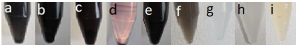
Figura 11. Examinarea vizuală a virării culorii după 144 h de incubare a probelor de (a) Pt la întuneric; (b) Pt la lumină; (c) Au la lumină; (d) Au la întuneric; (e) Pd la lumină; (f) Pd la întuneric; (g) Pt la momentul inițial; (h) Au la momentul inițial (i) Pd la momentul inițial.
