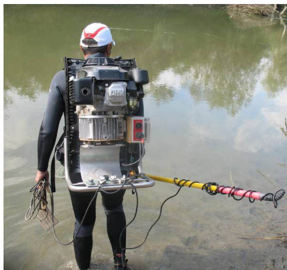
Foto. 36. Aparat de pescuit electric Tyo FEG 3000 (foto original)
