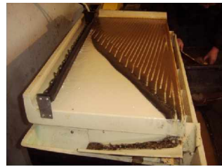
Masa de concentrare Wedag Wedag mass concentrator
