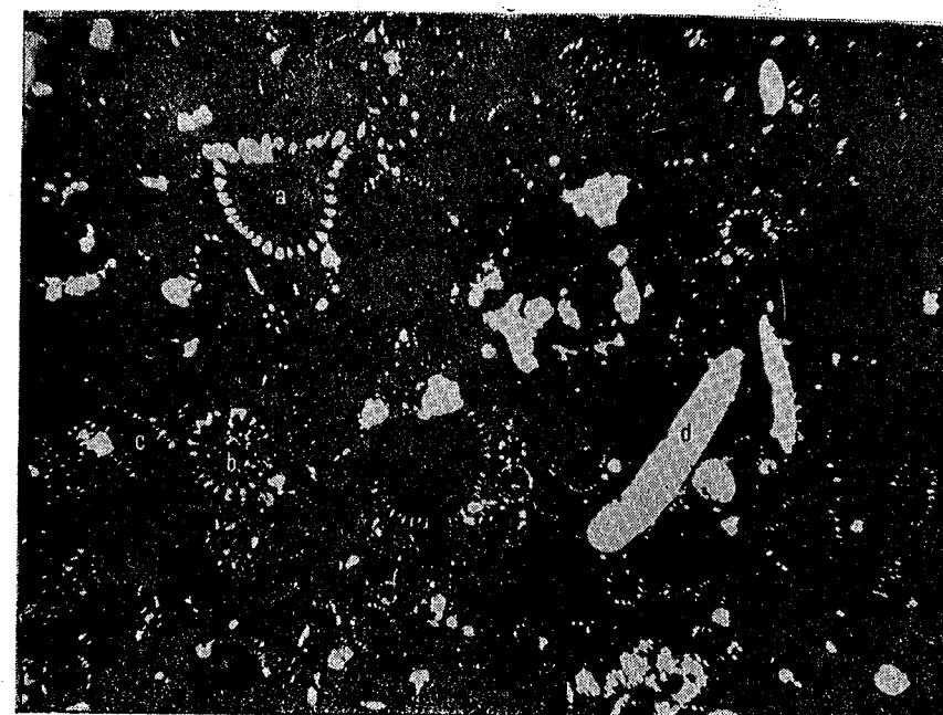
Fig. 1. — Radiolari cu scheletul silicios și cavitatea umplută cu oxizi de Mn. Spumellaria : a) Stichocapsa , b) Cenosphaera ; Nassellaria : c) Lithocampe (?); Spicule de Spongieri, d) Formă monaxonică (× 75)
